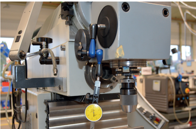
Befestigung von Messgeräten am Maschinengehäuse
